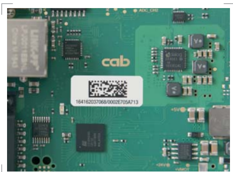
Marquage de circuits imprimés
