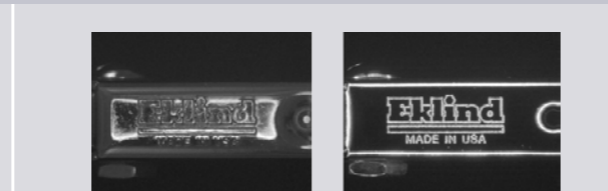
Objet: Logo gaufré sur une surface en métal. L'éclairage à faible angle permet d'obtenir une image à contraste élevé.
